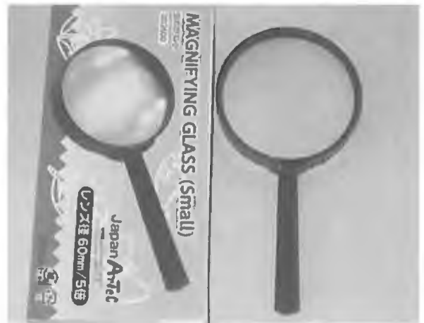
むしめがね (直径45~60mm、焦点距離150~200mm)
