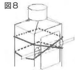
⑦ 細めの針金を20cmに切り、竹ぐし1とペットボトルをしばって固定する。(図8)
