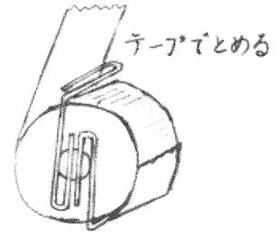
(4) 回転部をペットボトルに開けた開口部から差し込み、取り付けます。竹ひごはちょうどよい長さでカットする。
