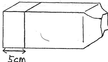
(3) 内側の筒にしたパックの底に、レンズの直径より少し小さい直径の円を書き、カッターナイフで切り抜く。また、内側の筒の2つの横の面に3.5cmくらいの切れ込みを入れ、外側の筒の中に入りやすくする。
