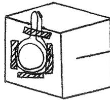
(5) 外側の筒の切り口部分から4 cmのところを中心にガムテープを1周巻き、補強する。そして、切り口部分から4 cmのところを図のように下から1.5cm程残して切断し、フィルムを入れる部分をつくる。その時、片方の側面だけ1~2 mmのすき間をつくるようにする。
