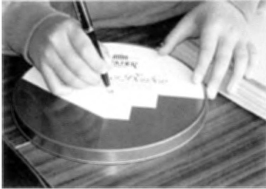
写真3 アルミ箔に穴を開けるところ
