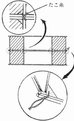
⑤下の図のように、胴体をVの字の形にして、前に主翼、後に尾翼を、ステー棒に輪ゴムをかけて組み立てる。
